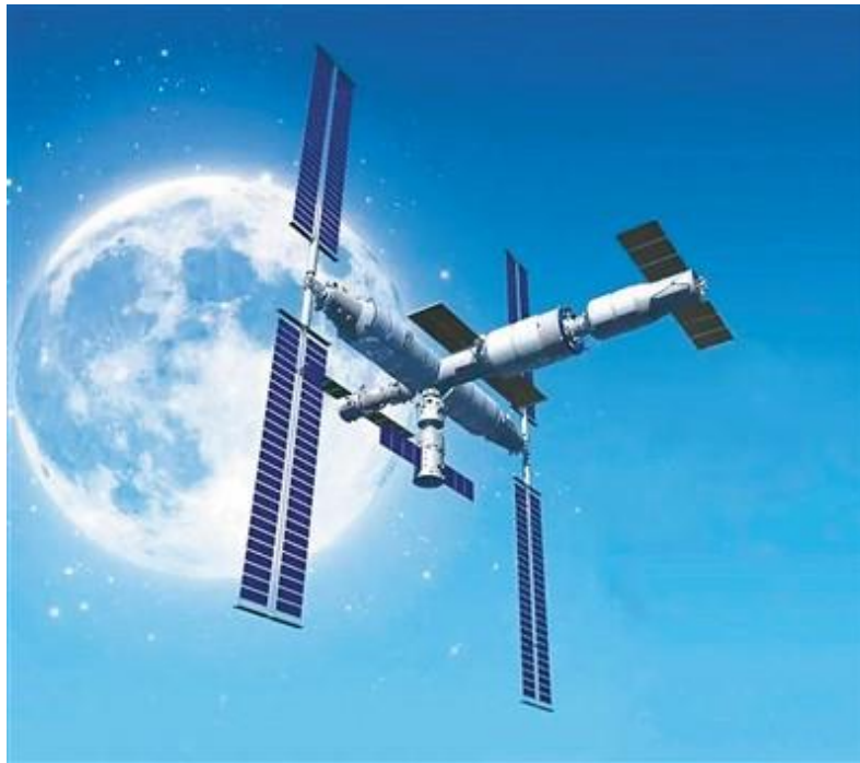
中國空間站 T 字構型示意圖平台。(圖片來源：中國航天科技集團)
